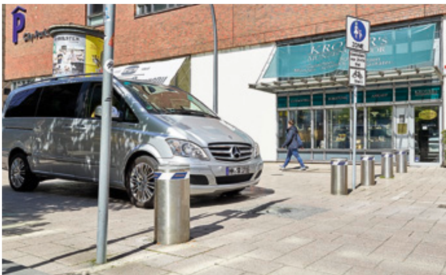
Über einen Handsender können befugte Verkehrsteilnehmer den Poller in den Boden versenken lassen.
